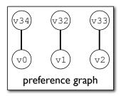
MOV v32,#19 MOV v33,#23 MOV v1,v32 MOV v2,v33 ADD v0,v1,v2 MOV v34,v0
