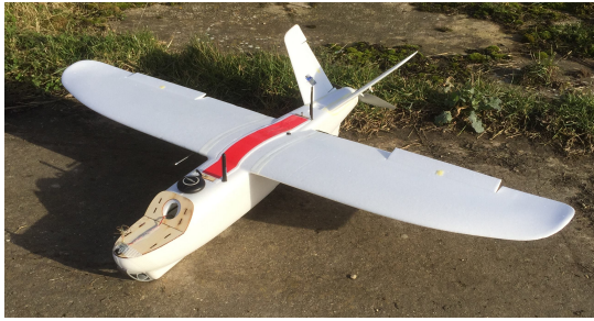
Fig. 3: The selected airframe, X-UAV Mini Talon.
