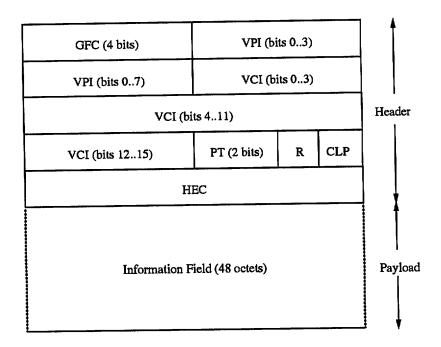
Figure 2.7: B-ISDN Cell Format
